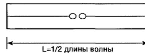
3-проводная петлевая дипольная антенна
